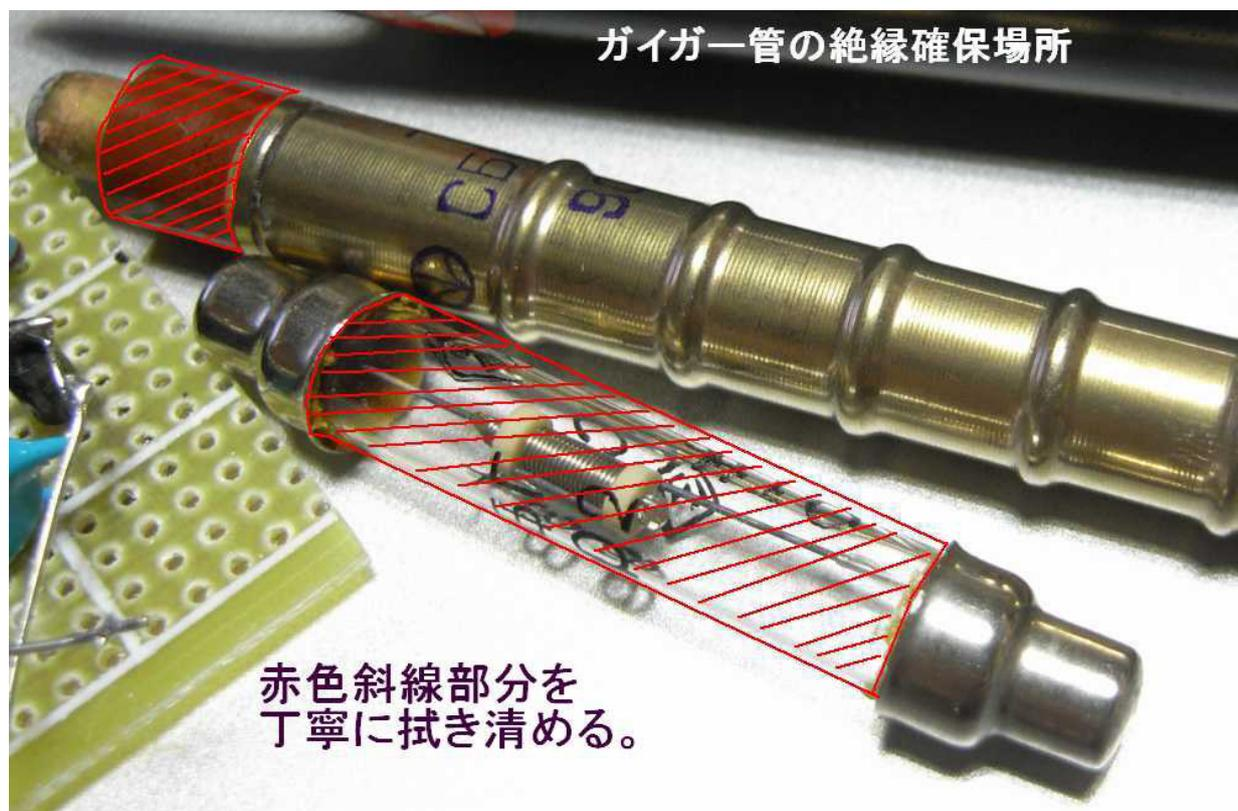
対策 2 ガイガーミュラー管のアノード(5.1M  $\Omega$ の付いているケーブル)配線を外し、テストしてみる。この状態で漏れがある場合は基板の漏電・・・→回路の洗浄。
