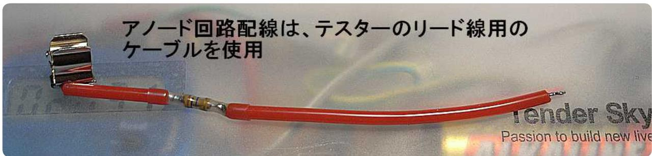
②写真のように 100K  $\Omega$ 、1000PF、線材、フューズホルダーを組み立てる。
