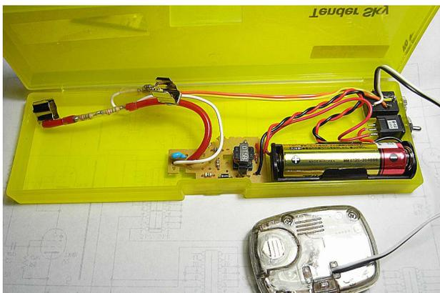
☆ケース（筆箱）の適切な位置にスイッチと出力ジャックを取り付ける必要があるので、その位置にマークを打ち、ドリルなどで穴あけをする。
