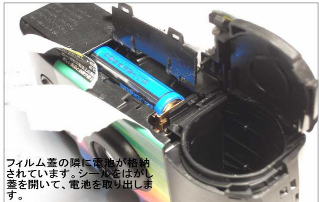
③カメラの化粧シールを剥ぎ取り、カメラ横の止めフックに細いマイナスドライバーなどを差込、カニの甲羅を開くような要領で、ボディを開く。
