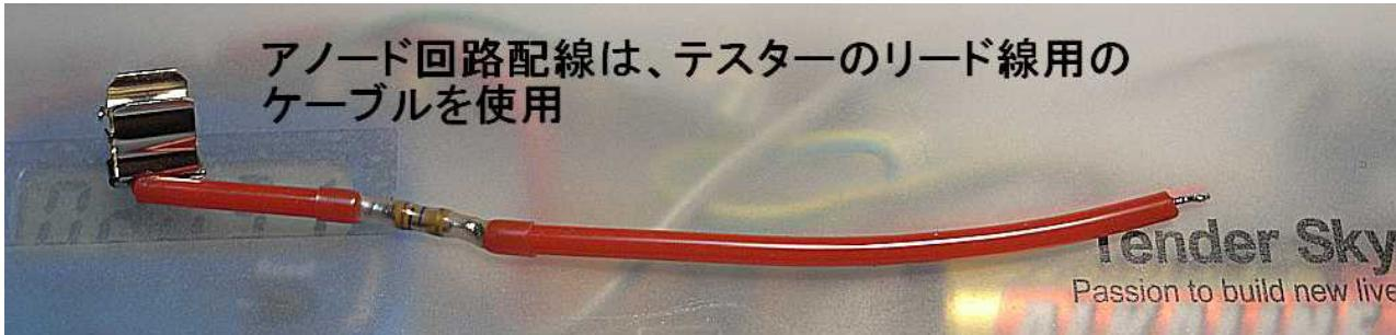
\*写真のように  $100K\ \Omega$ 、 $1000PF$ 、線材、フューズホルダーを組み立てる。
