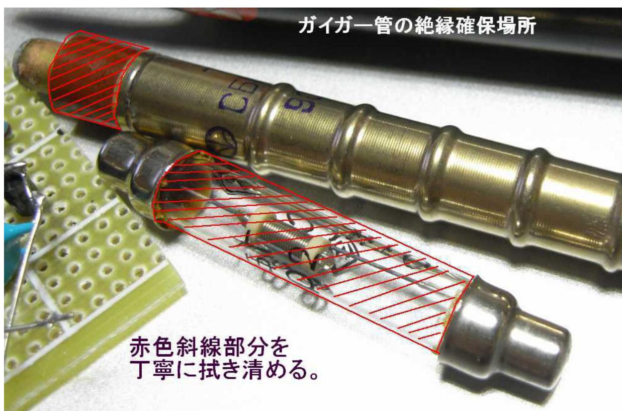
②ガイガーミュラー管のアノード（ $10M\Omega$ の付いているケーブル）配線を外し、テストしてみる。
