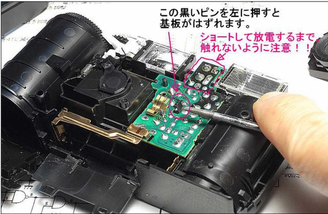
⑤完全に放電できたら、フラッシュ基板の止めツメを押しながら、基板を外す。
